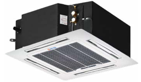
Четырехпоточный компактный фанкойл 3,0 - 4,5 кВт (двухтрубная система) 2,5 - 3,5 кВт (четырёхтрубная система)
