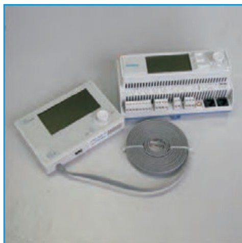
Контроллер Siemens – Climatix и панель оператора HMI
